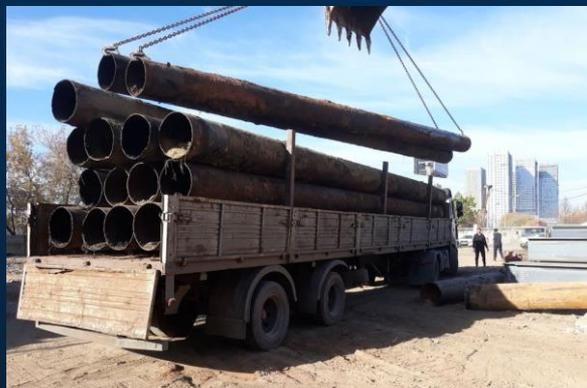
09.10.21 г. труба б/у  $\varnothing 530 \times 8$  мм
