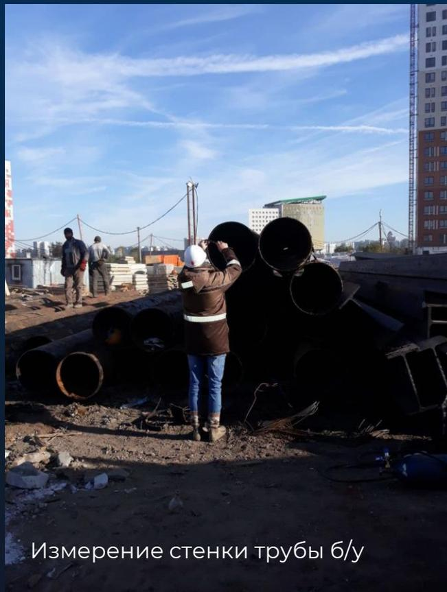
Измерение стенки трубы б/у
